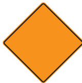
تحذر من مناطق أعمال التشبيد
