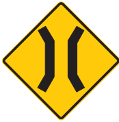
أمامك هيكل ضيق - غالبًا جسر
